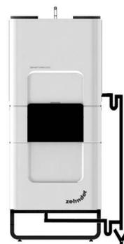
13. Zdemontuj nakładki zabezpieczające z urządzenia i podłącz kanały powietrza.
