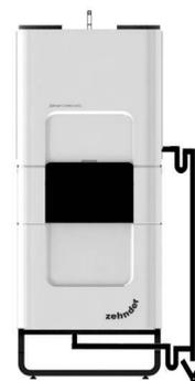
13. Verwijder de hygiënische covers van het toestel en sluit de luchtkanalen aan.
