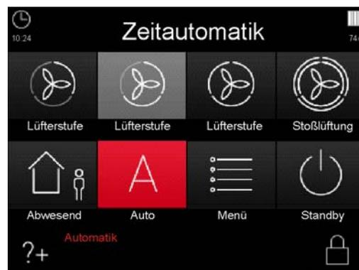
Abb. 8: Automatik-Modus Zeitautomatik mit aktiver Lüfterstufe LS2
