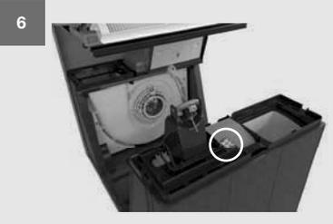
Entfernen Sie die Ventilatoranschlüsse aus der Sensorabdeckung und öffnen Sie Steckverbindung.
