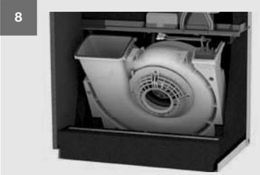
Heben Sie das Spiralgehäuse aus dem Gerät heraus.
