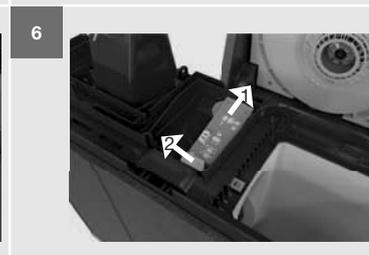
Ziehen Sie den Sensor nach oben und aus seiner Gummihalterung heraus. Ziehen Sie dann den Sensor zur Seite und aus dem Sensorfach heraus.
